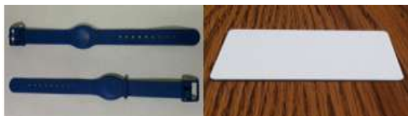
Fig. 2. Pulsera MIFARE (ISO 15693) portada por los niños y tarjeta RFID (ISO 15693) para registrar las actividades.
