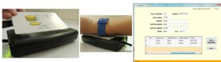
Fig. 7. Lector RFID lee el ID de la tarjeta para el registro de la actividad (izquierda), registro del alumno (en medio) y pantalla de la actividad registrada (derecho).
