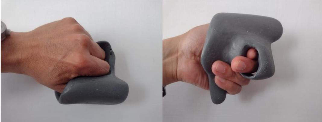
**Figura 12.** Modelo final fabricado en resina con moldes de silicón, obtenido como réplica de las órtesis fabricadas por los deportistas.
