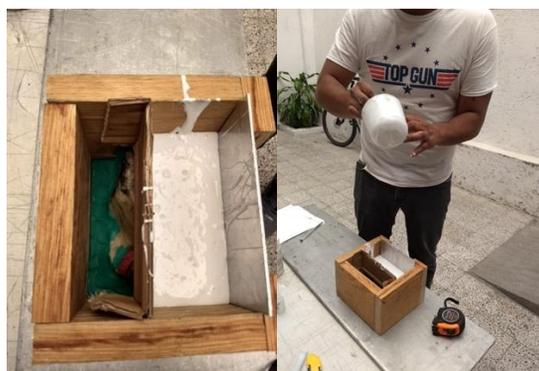
**Figura 10.** Elaboración de molde de silicón para realizar una réplica de la órtesis artesanal.
