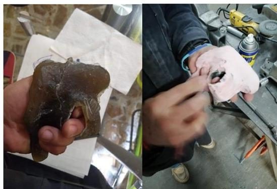
**Figura 11.** Modelo de resina que necesitó de trabajo posterior para corregir algunos huecos y retirar sobrante de material.
