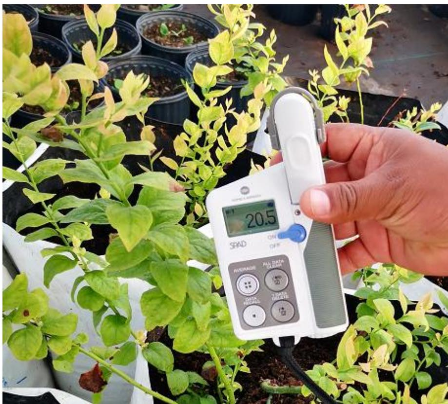
Fig. 11 Dispositivo SPAD-502 (*Soil Plant Analysis Development*) para medición de nitrógeno.
